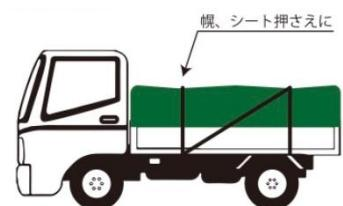
トラックの幌紐、現場のシート押さえ、荷物の固定に利用できます。柔軟で良く伸びるため取り回しが良く、中空構造でかかる力を分散します。ゴム同士の摩擦が強いため、簡単な結び方で強固に繋ぐことができます。
