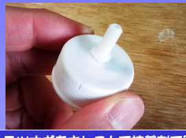
エアースツナギをさしこんで接着剤で固定します
