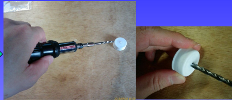
さらにハンドドリルで直径5mmの穴を開けます
